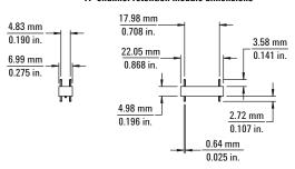
Figure 8.11. Retention module dimensions
