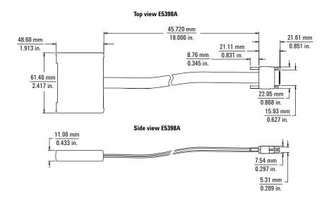
Figure 8.10. Probe dimensions
