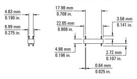
Figure 5.7. Retention module dimensions
